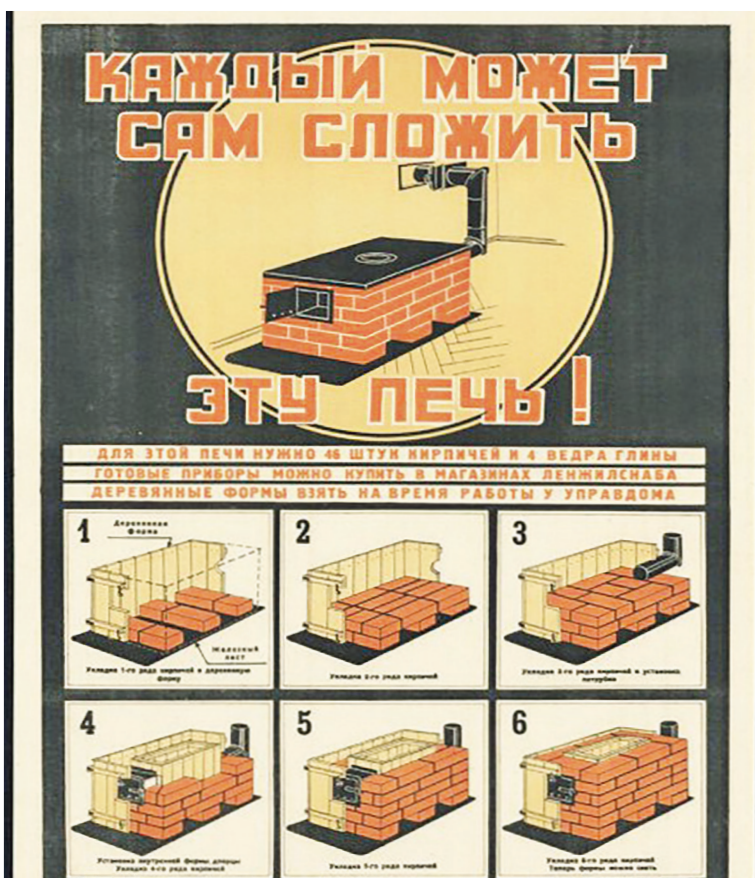
В 1942 году в Ленинграде печатали плакаты с подробной инструкцией по самостоятельной сборке кирпичной печи-времянки
